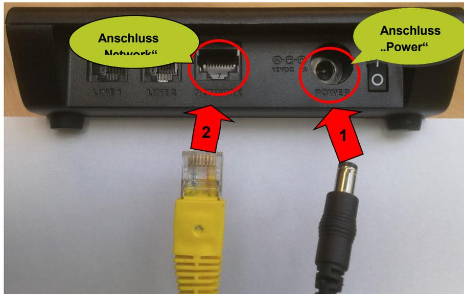
Um das analoge Telefon bzw. Faxgerät mit dem ATA zu verbinden, muss nun das RJ11-Kabel (Telefonkabel) des anzuschließenden Geräts in den Anschluss LINE 1 gesteckt werden. Danach muss der neben dem „Power“-Anschluss befindlichen An/Aus-Schalter auf I gestellt werden.
