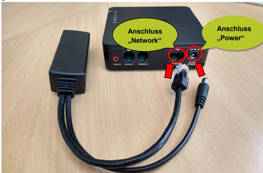
Weiter muss in den POE SPLITTER muss das Netzwerkkabel eingesteckt und mit einer freien (gepatchten) Datendose verbunden werden.
