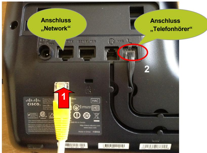
Stecker des neuen schwarzen Telefonkabels (liegt anbei) in den Anschluss „Computer“ stecken und das andere Ende in den Anschluss des Endgeräts (PC) stecken, in dem sich vorher das Netzkabel befand.
