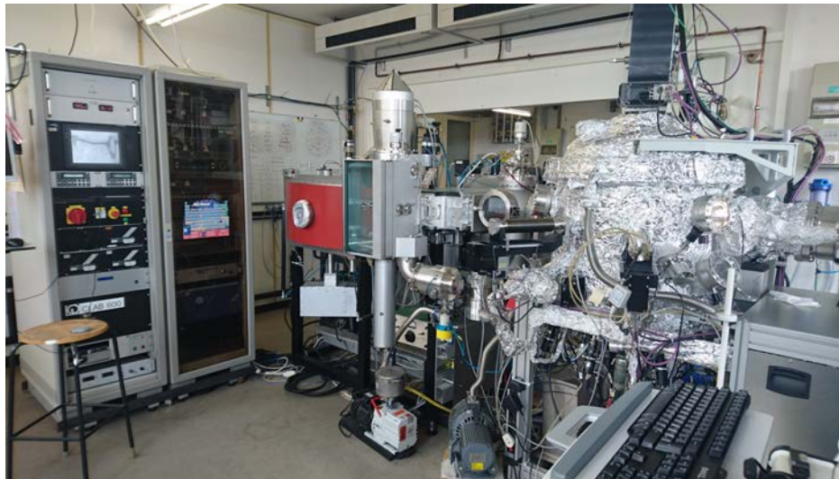
Kombinierte Sputter- und Molekularstrahlanlage der Arbeitsgruppe Reiss: mit dieser Anlage können dünne Schichten aus verschiedenen Materialien atomlagenengenau hergestellt werden.
